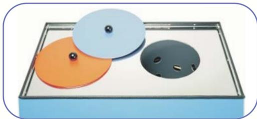
Der Froster HD F 32 / F 45 ist mit seinem sehr großen Kälte- und Wärmetank insbesondere für das Einfrieren und Auftauen der Mischstrecke mit vermischtem Material geeignet. Die Reaktion des Materials wird unterbrochen und bei erneutem Bedarf im Wärmetank umgehend aktiviert.
