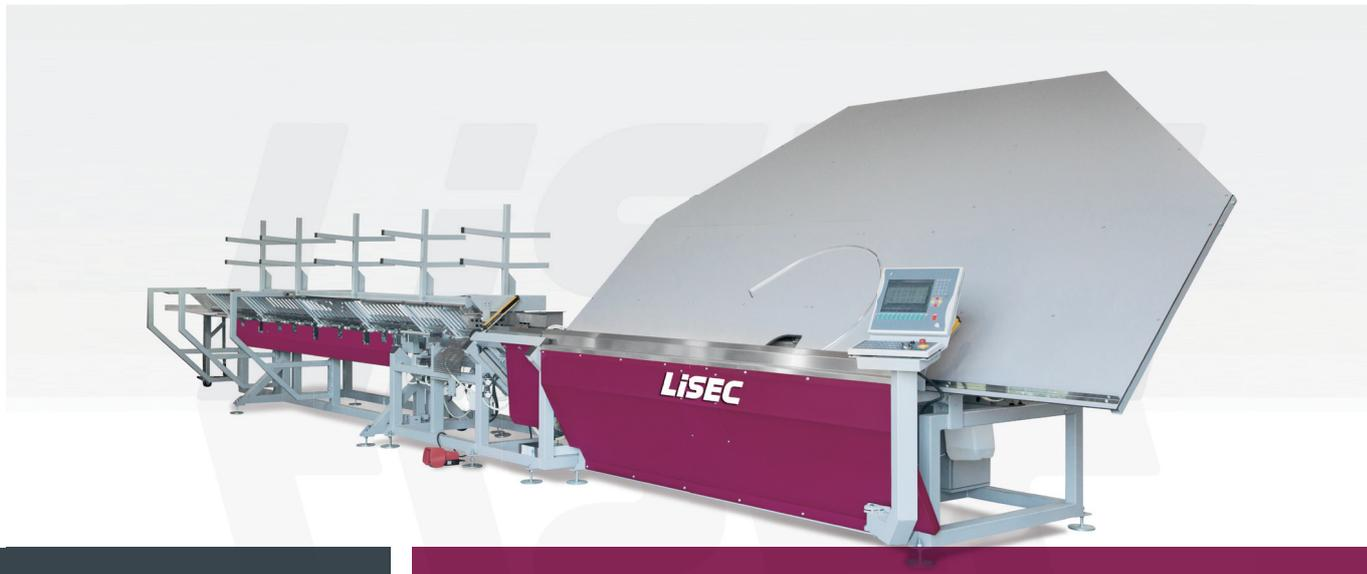
Biegemaschine mit 45° geneigter Arbeitsplatte zur Herstellung von Abstandhalterrahmen in beliebigen Winkelgraden. Für Stahl- und Alu-Profile sowie für das Befüllen mit Trockenmittel nach dem Biegen. Mit automatischer Steckvorrichtung zum Verbund der Profilen. Maßdatentransfer online oder durch Eingabe am Bedienungsterminal.
